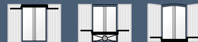
Position sous linteau
